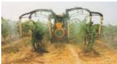
Atomizador bifilar para viñedos
